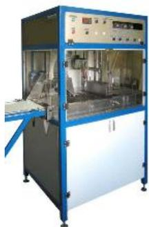
**Декорирующая машина ДМ с выкатной ванной** предназначена для декорирования кондитерских изделий шоколадной глазурью. Позволяет наносить различные узоры наверх кондитерских изделий с одновременным глазированием дна изделия (одним цветом). Используется в составе технологической линии глазирования и декорирования кондитерских изделий. Машина декорирования оснащена системой автоматической пробивки форсунок декоратора, каплесьёмным обогреваемым валиком, петлевым декоратором.
